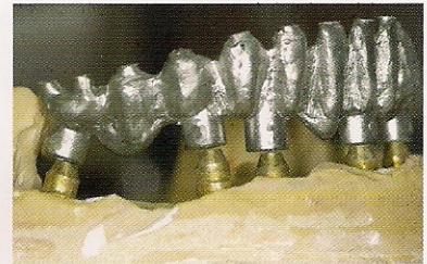
FIGURA 9. Tras el colado, la distorsión y desajuste de la supraestructura suele ser el resultado de la fase de enfriamiento del procedimiento.
