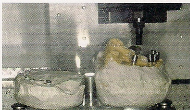
FIGURA 10. La supraestructura se somete al proceso de obtención de precisión, donde se programan las alturas a las que se desea cortar los extremos apicales de la misma, así como la de los soportes definitivos.
